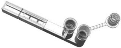
图 1 核酸反应管和封闭式扩增产物检测装置
